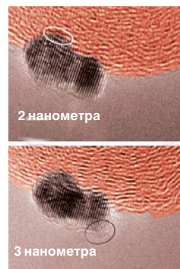
Золотые кластеры (обведены на рисунке) замедляют процесс окисления платиновых катализаторов в клетке топлива
