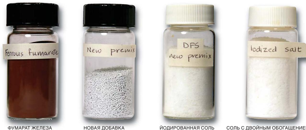
КЛЮЧ к изготовлению обогащенной соли, приемлемой для потребителей, — в том, чтобы придать железу внешний вид соли. В этих флаконах (слева направо): частицы железа; железо, покрытое диоксидом титана; йодированная соль; йодированная соль, смешанная с инкапсулированным железом
